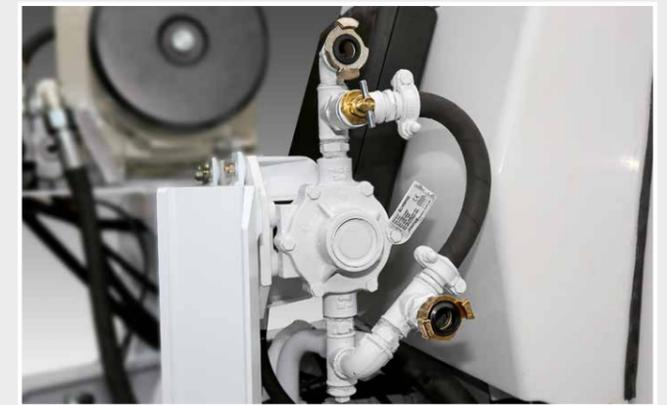
La pompe à eau facilite le nettoyage après la fin du bétonnage grâce à un débit de 80 l/min et une pression d'eau maximale de 20 bars.
