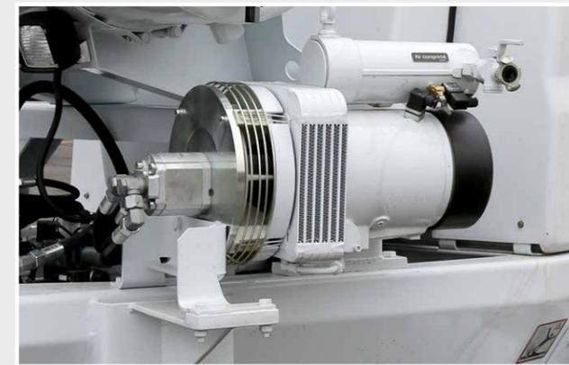
Le puissant compresseur d'air allant jusqu'à 13 bar permet un nettoyage de la tuyauterie (lance balle, en option).
