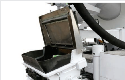
Couvercle de trémie en position „Remplissage externe“
