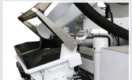
Couvercle de trémie en position „Remplissage propre + externe“
