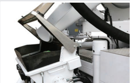
Couvercle de trémie en position „Remplissage propre“
