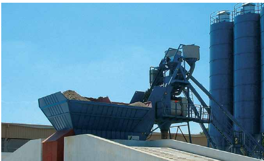
Silo à 4 poches, pouvant être chargé à l'aide des rampes placées de chaque côté. Le chargeur plat sert alors simultanément de récipient de pesage.
