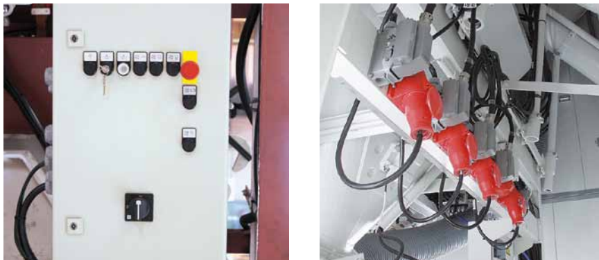
Des connecteurs pour le raccord électrique de la périphérie facilitent le montage et le démontage.
