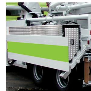
Les flexibles sont placés dans des boîtes amovibles hydrauliques qui permettent une utilisation aisée.
