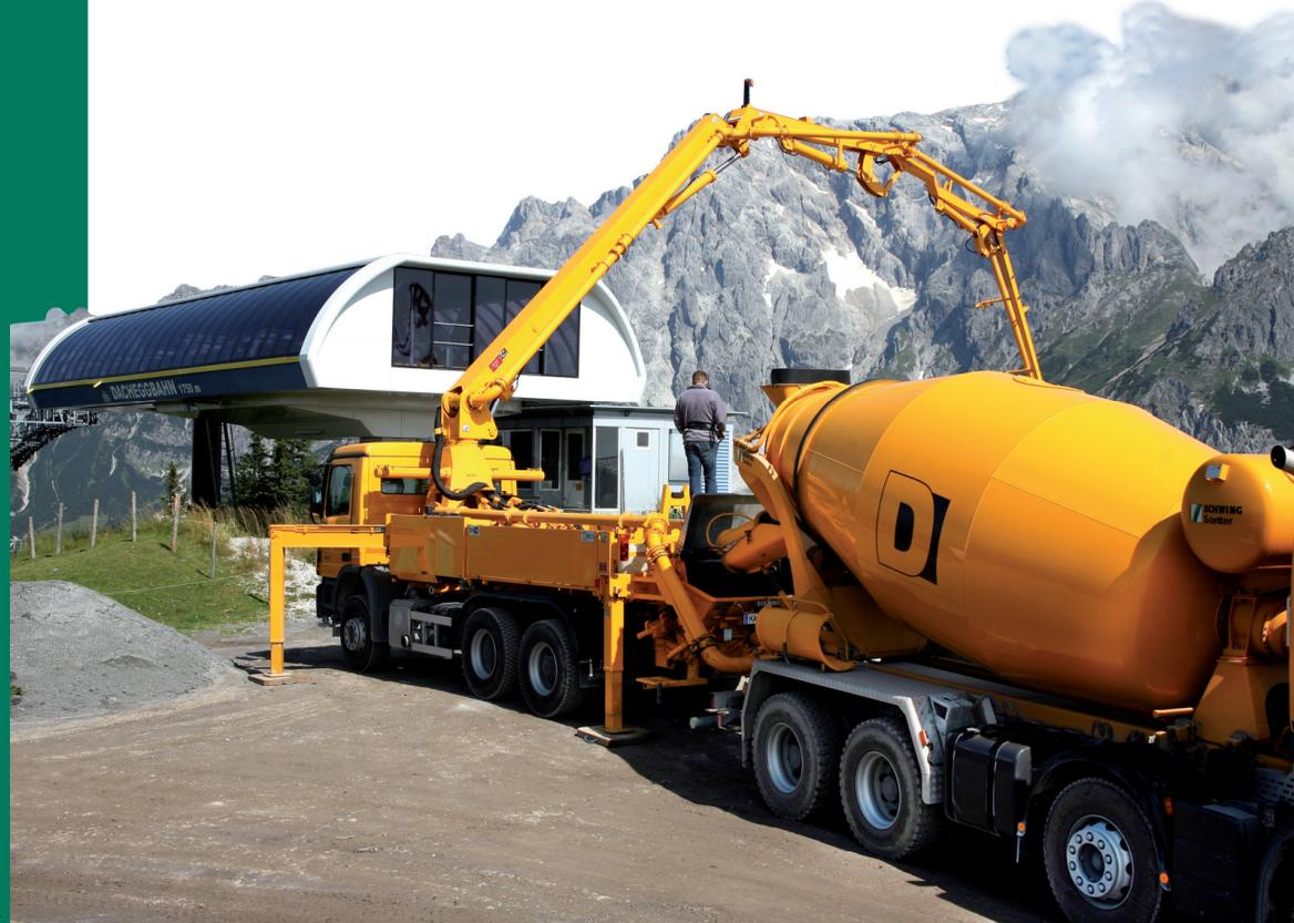
SCHWING, grâce à sa construction légère parvient à un poids total de 18Tonnes sans compromis avec les groupes de pompage, le rock et la flèche.
