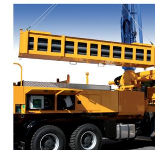
les boîtes de rangement placées sur la droite de la machine peuvent être manutentionnées par chariots élévateurs, grues ou par la propre flèche.
