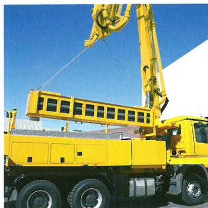
Des boîtes à tuyaux supplémentaires pour tubes et tuyaux peuvent être déposés selon besoin pour chariot élévateurs, grues et par leur propre flèche.
