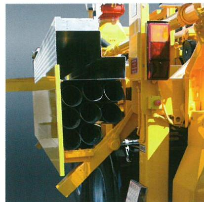
La boîte de tuyau hydraulique peut être manoeuvrée sans stabiliser la machine et reprends les flexibles confortablement dans les gaines.
