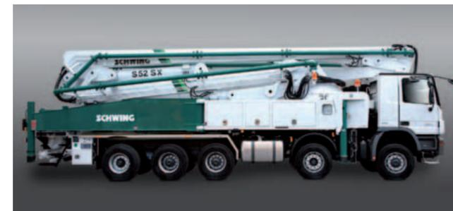
Les pompes à béton automotrices proposent une répartition optimale de la charge sur 5 axes car le groupe de mâts compact n'est pas en surplomb. Les points d'articulation des étalements arrière se trouvent sur le premier axe arrière, ce qui permet un support sécurisé de l'engin lors du pompage.
