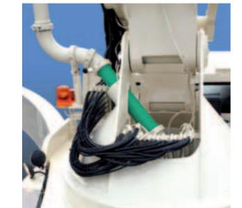
Le déploiement idéal des conduites hydrauliques et de la colonne montage garantit un accès facile au plateau rotatif.
