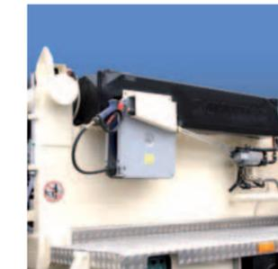
Le grand réservoir d'eau 600 l est placé juste à côté de la trémie et peut être équipée en option d'un nettoyeur haute pression et d'un système de chauffage de l'eau.
