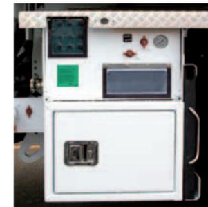
Le « poste central » contient, en plus du panneau de commande avec réglage pneumatique et les postes de vannes, une « boîte à lettres » destinées aux bons de livraison.
