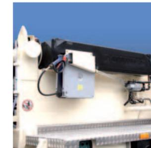
Le réservoir d'eau de 600 l est situé juste à côté de la trémie et peut être équipé en option d'un nettoyeur haute pression et d'un système de chauffage de l'eau.
