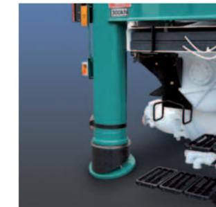
Facilité d'utilisation : Les supports de potences coulisent sur roulements sur les étalements avant et arrière.
