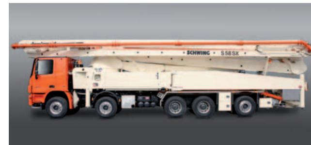
Le faible poids (48 t) permet d'améliorer la flexibilité, la rapidité et les réserves de poids. Les châssis 5 axes garantissent une plus grande manœuvrabilité, sur la route comme sur les chantiers.
