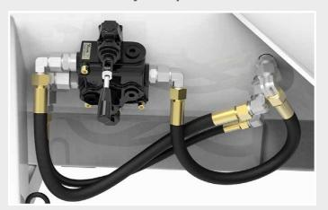
L'unité de commande hydraulique de la SP 2800 permet de commander sans difficulté des composants comme par exemple la vanne d'arrêt (avec une pression maximale de 210 bars et un débit maximal de 30 l/min).
