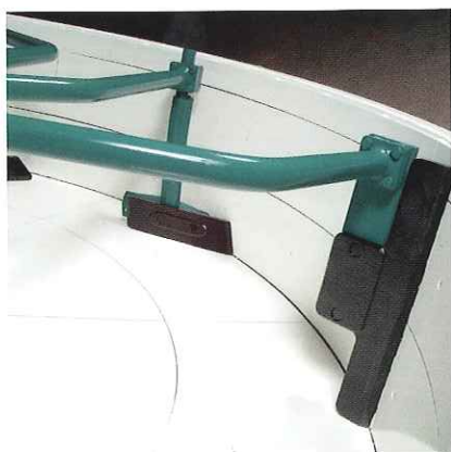
Les racloirs extérieurs et intérieurs favorisent le mélange et la distribution de l'agrégat.
