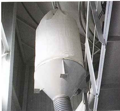
Dans sa version standard, le dépoussiérage s'effectue au moyen d'un coussin d'air hermétique.
