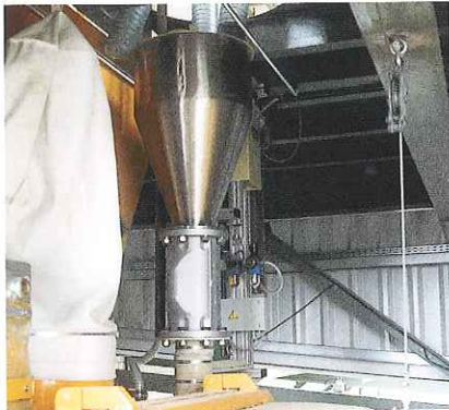
Balance à poudre d'alimentation en granulats colorés ou en microsilice.
