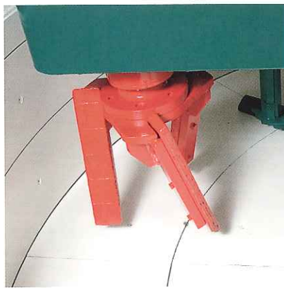
Le cyclone permet d'obtenir une très bonne homogénéité du béton et une préparation optimale de la colle de ciment.
