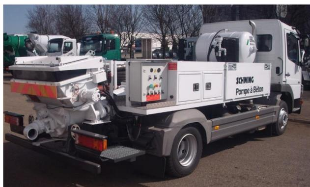
Photos non contractuelles. Exemple de pompe montée sur châssis Mercedes Benz ATEGO 924.
